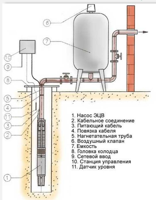
При работе насос ЭЦВ в скважине устанавливается вертикально двигателем вниз. Для этого осуществляют его монтаж на водоподъемную трубу при помощи резьбы или фланца на выходе из насоса. Насос подключается к питающему проводу и опускается в скважину. Управление работой насоса ЭЦВ осуществляется при помощи станций управления. Для защиты от сухого хода в скважине должен быть датчик уровня.
